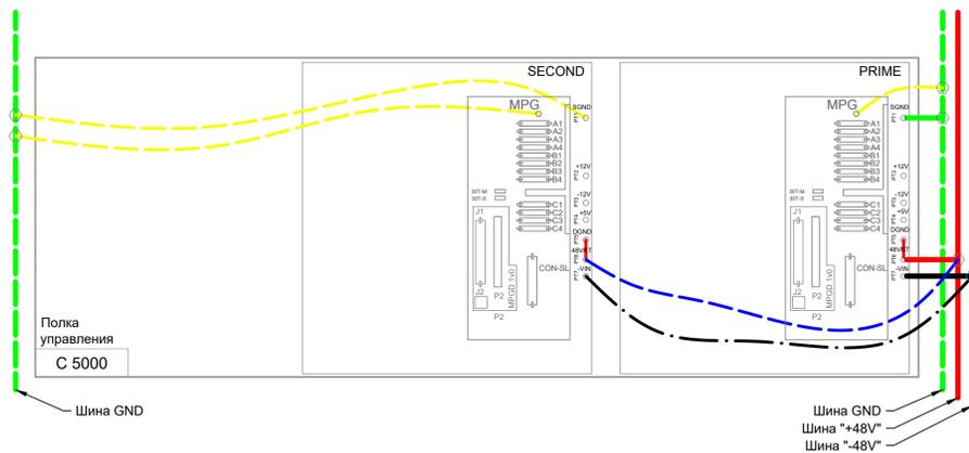
4. Схема подключения кабелей системы PCM&HDLC.
