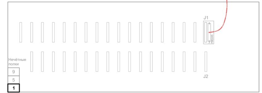
7. Схема подключения кабелей синхронизации.
