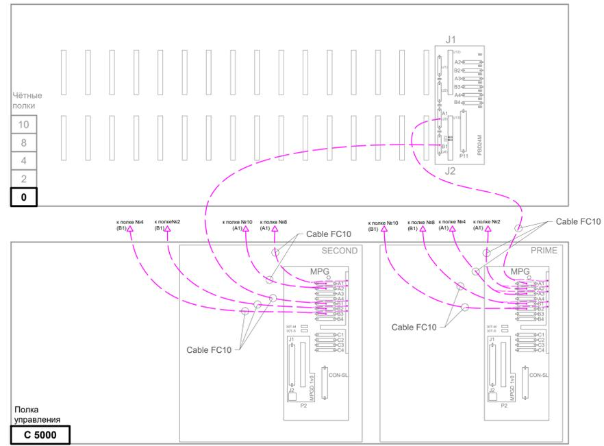
5. Схема подключения кабелей системы Clock&Sync\_Signal (FC9) и Alarm (H41).
