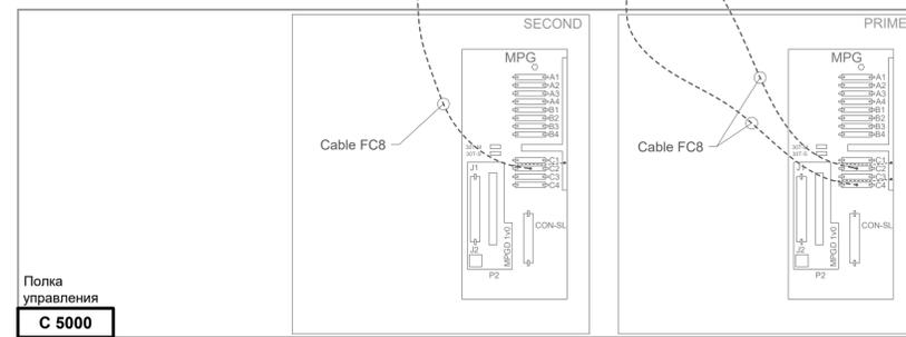
6. Схема подключения нечётных полок к чётным.
